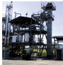
Impianto di gassificazione policombustibile a letto fluido da 160 KWe
