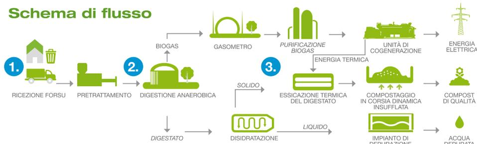
le e favorire la produzione del biogas il materiale all'interno dei digestori viene rimescolato in continuazione. Il biogas, così prodotto, esce costantemente dai digestori ad una pressione di 25 mbar, viene convogliato verso un primo trattamento di desolfurazione, per essere poi accumulato all'interno di un gasometro con funzione di serbatoio per l'alimentazione del cogeneratore.
