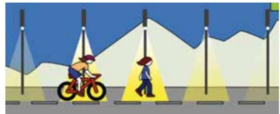
**PILG: Photinus Intelligent Light Guard** für die BEDARFSORIENTIERTE Lichtsteuerung. Beleuchten nur wenn es benötigt wird erhöht die Effizienz und vermeidet Lichtverschmutzung. PILG ist ideal auch für Radwege, bei Mastdistanzen bis zu 50m können sehr kostengünstige Lösungen realisiert werden.
