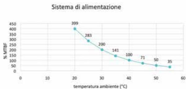
A sinistra il grafico completa le considerazioni fatte. I dispositivi che esercitano effettivamente il servizio richiesto sono, ovviamente, anch'essi sottoposti alla regola del degrado della vita utile all'aumentare della temperatura operativa. L'esempio riguarda un gateway di calcolo universale di ottima marca. 40 °C e carico elettrico al 50% sono i riferimenti della documentazione di apparato.
